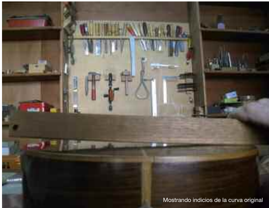
Alturas que alcanza la barra al medir la curva original
